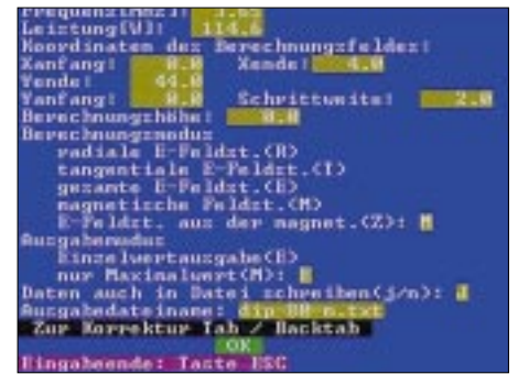
Bild 6: Weitere Eingaben in FS3D; die 3 m Sicherheitsbereich wurden bereits bei der Eingabe der Antennenkoordinaten abgezogen, deshalb gilt hier Berechnungshöhe = 0 m.
