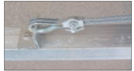
Bild 25: Stahlseil mit Kausche und Kastenklammer zur Abspannung des Booms
