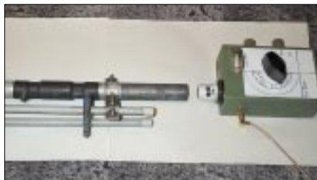
Das Dippen der Sperrkreise erfordert höchste Aufmerksamkeit, da der Dip sehr schwach ausfällt. Foto: DK4PL
