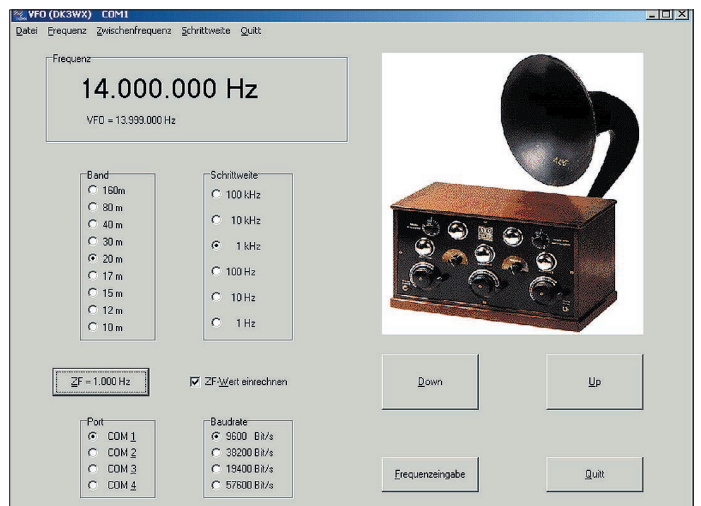
Bild 2: Das vom Autor erstellte Programm Softradio ist speziell für den Einsatz des NWT als Hauptoszillator eines Direktmischempfängers zugeschnitten. Screenshot: DK3WX
