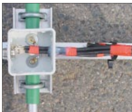
Bild 2: Anpassleitung mit RG59-Kabeln in bzw. neben der Strahlerdose
