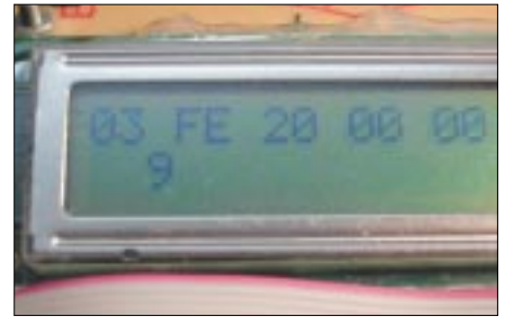
Bild 5: LC-Anzeige im Modus 1. Die Werte haben folgende Bedeutung: 03 = 3 Byte folgen; FE = Empfängeradresse FEH; 20 = 1. Datenbyte; 00 = 2. Datenbyte; Ende des I 2 C-Datenpakets Fotos: DF2OAG
