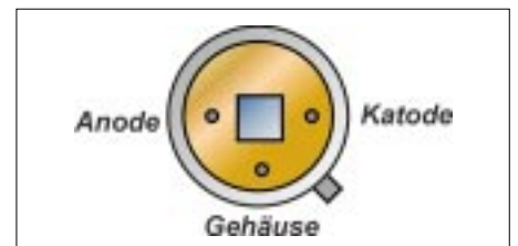
Bild 9: Zur Ermittlung der Pinbelegung der Fotodiode schauen wir auf das Gehäuse.
